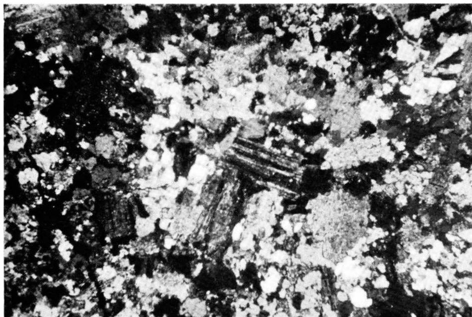
Фиг. 37. Структурный рисунок кварц-полевошпатовых метасоматитов, Дыбыкениское месторождение (карьер). Никколи скрещены, увел. 40.
