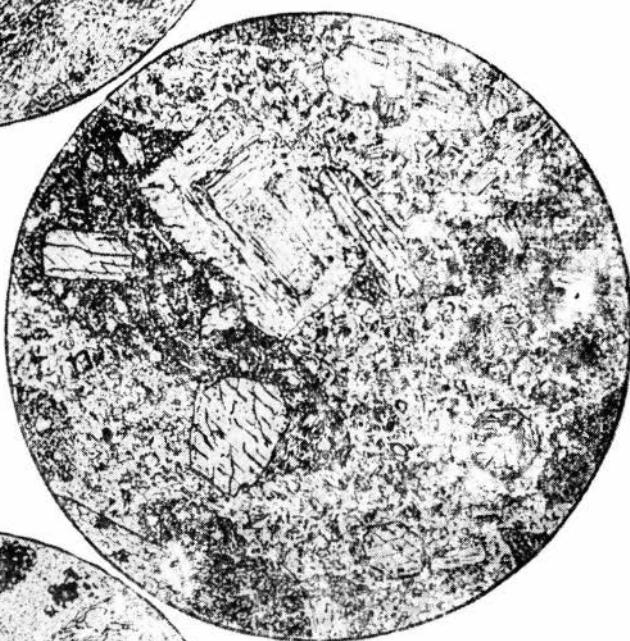
Фиг. 15. Лавобрекция андезитового порфирита, падь Ужбогоё, алханайская свита. Николь \perp , d = 4,0 мм. Основная масса изобилует обломками с фельзитовой структурой и порфировыми выделениями плагиоклаза, пироксена и хлоритизированной роговой обманки.
