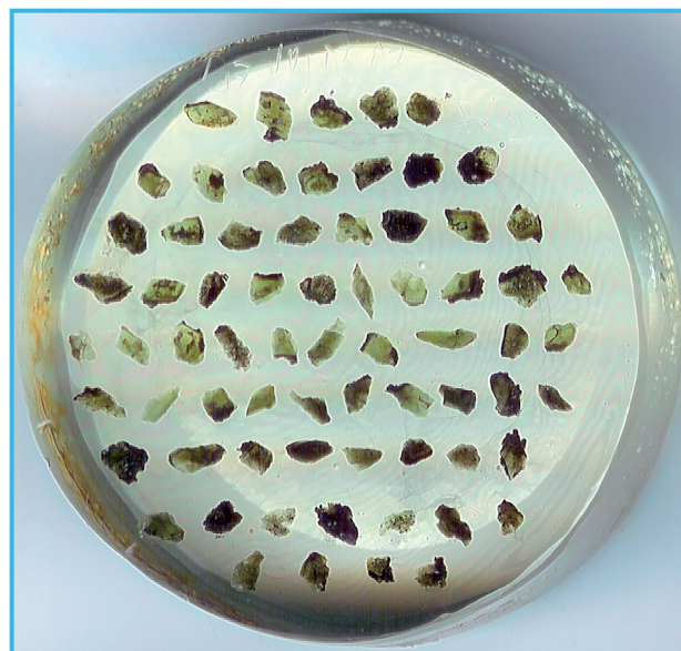
Рис. 2-04. Общий вид мономинеральной микрозондовой шашки для изучения состава кристаллических фаз. В шашке 69 кристаллов клинопироксена из образца лавового потока Заварицкого (прорыв Юбилейный), извержение 1945 г. Фракция 1–2 мм. Диаметр шашки – 25 мм
