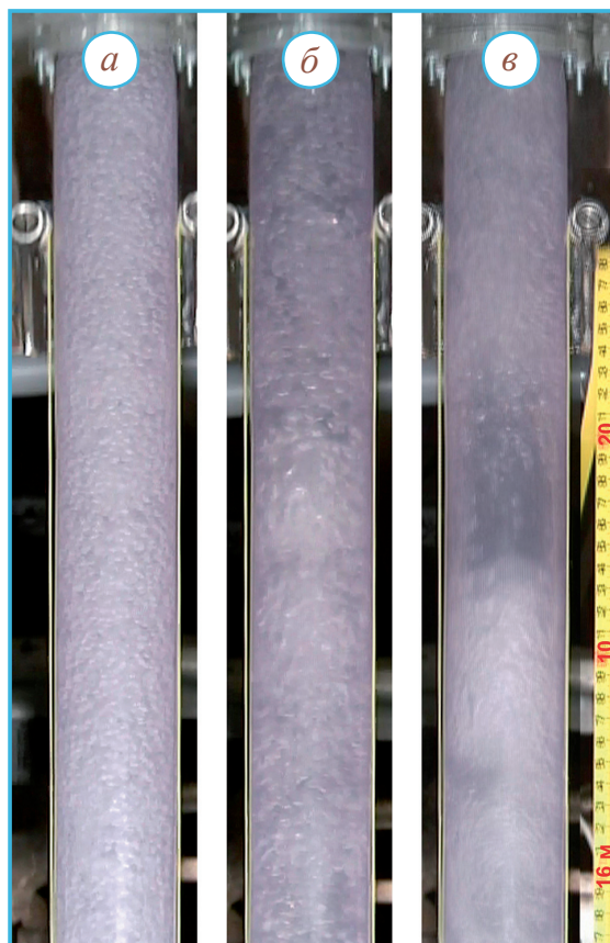
Рис. 5-01. Фрагменты газогидродинамических режимов, возникающих в верхней части вертикальной прозрачной колонны ( \varnothing_{\text{внутр.}} = 50 мм, h = 16,6 м), при разных начальных расходах подачи модельной газонасыщенной жидкости.
