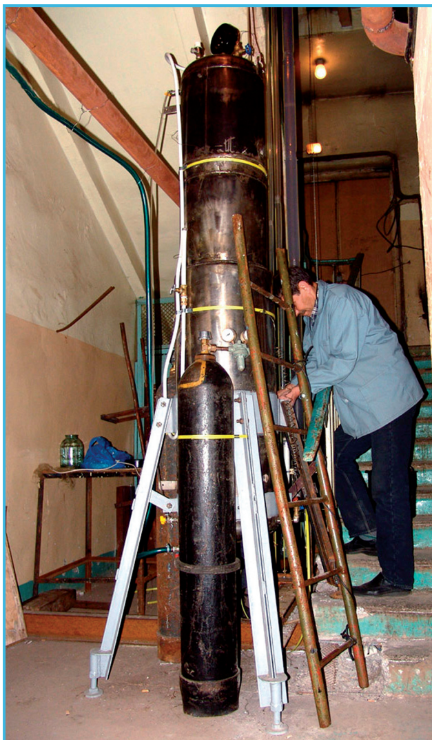
Рис. 4-13. Внешний вид бака для приготовления газонасыщенной модельной жидкости
