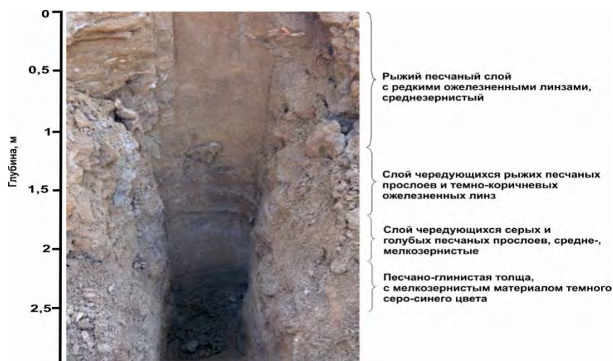
Рисунок 5.3 – Вертикальный разрез старого хвостохранилища КОФ. Шурф 1
