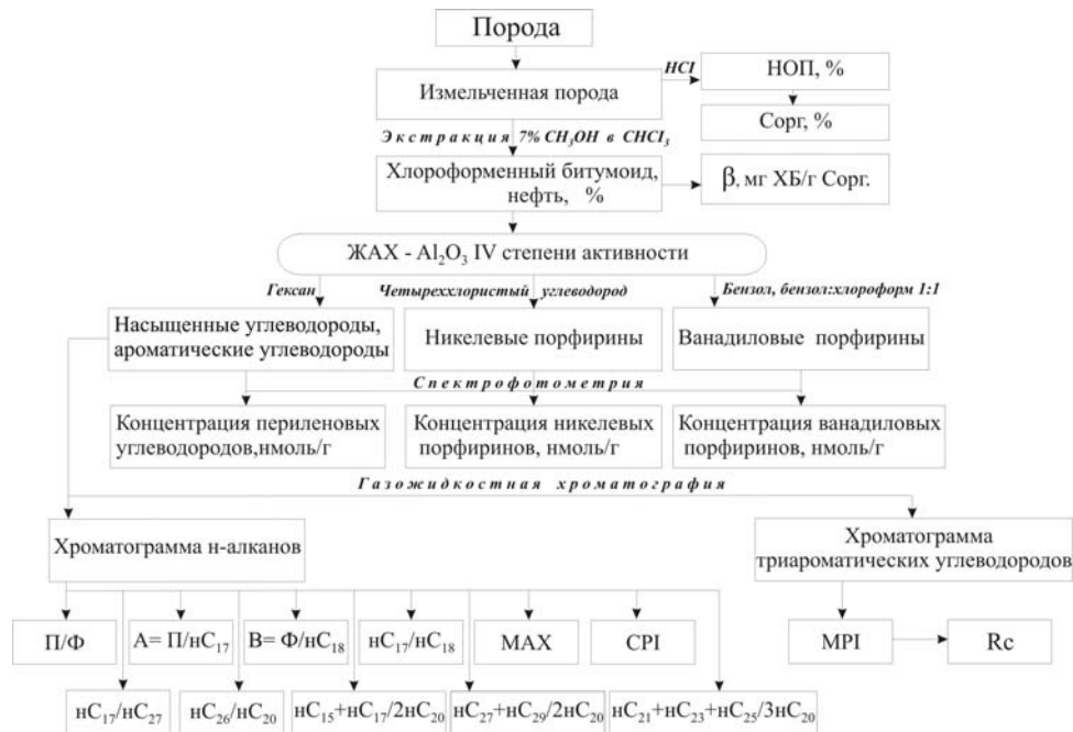
Рисунок 1 – Общая схема выделения и исследования РОВ и нефтей
